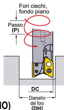
**LAVORAZIONE IN RAMPA/TAGLIO ELICOIDALE (LEGA DI ALLUMINIO)**
