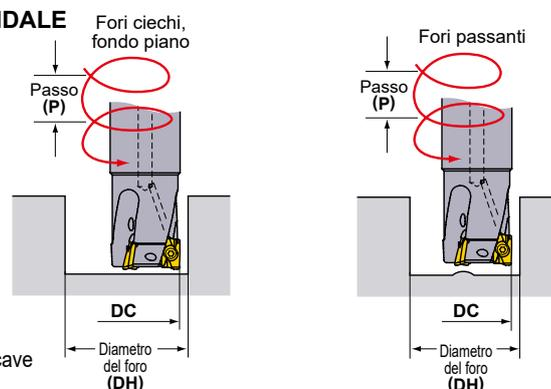
La tabella seguente si riferisce ad inserti con raggio di 0.8 mm. Usare i parametri di taglio per cave per calcolare la velocità e l'avanzamento per le lavorazioni in rampa o per interpolazione.
