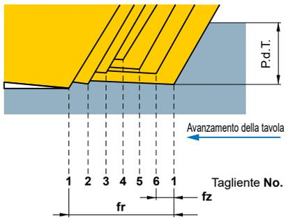
Dato che la larghezza normale del tagliente secondario dei materiali Mitsubishi è di 1.4 mm e i taglienti secondari sono impostati parallelamente al petto della fresa, in teoria la precisione della superficie finita dovrebbe essere mantenuta anche con scarsa precisione di eccentricità.
