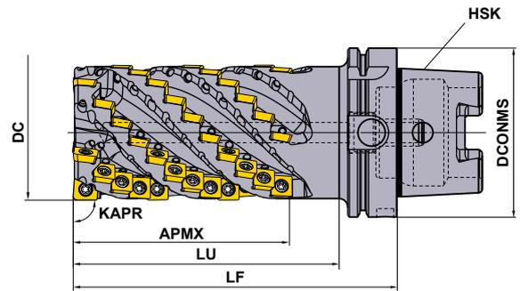
La fresa standard è solo destra (R). La fresa monoblocco con attacco HSK viene fornita con il tubetto per il lubrorefrigerante integrato.
