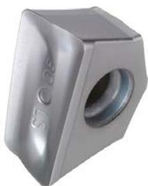
Un avanzato substrato in metallo duro sub-micrograna aumenta la tenacità pur mantenendo la durezza. Il rivestimento Al-Ti-Cr-N garantisce una resistenza ottimale al calore e all'usura. La combinazione di queste proprietà assicura un'eccellente resistenza alla rottura e all'incollamento, grazie al basso coefficiente di attrito durante la lavorazione di leghe di titanio.
