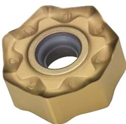
MP7030 ha un rivestimento multistrato basato sull'innovativo composto (Al,Ti)N-Ti. Garantisce una migliore resistenza all'usura e alla rottura nella lavorazione di acciaio inossidabile. Uno speciale substrato tenace in metallo duro garantisce prestazioni eccellenti nella lavorazione di materiali difficili da tagliare, come l'acciaio inossidabile.
