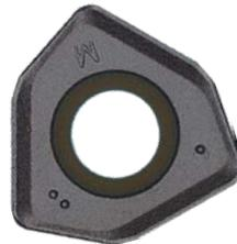
Gli strati di Al<sub>2</sub>O<sub>3</sub> resistenti all'usura e quelli fibrosi di TiCN offrono un'eccellente resistenza all'usura nel taglio ad alta velocità. L'utilizzo di un carburo cementato appositamente sviluppato garantisce una resistenza superiore alla rottura ed alla scheggiatura da shock termico e previene il cedimento improvviso del tagliente.
