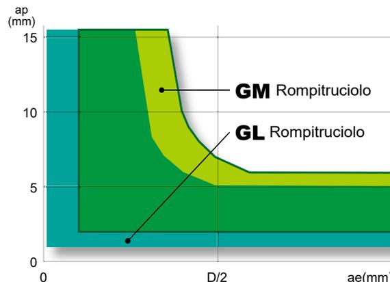
La 1<sup>a</sup> scelta per la lavorazione di leghe di alluminio è il rompitruciolo GL.
