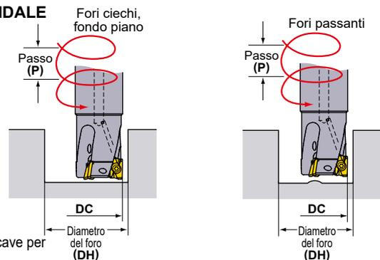
La tabella seguente si riferisce ad inserti con raggio di 0.8 mm. Usare i parametri di taglio per cave per calcolare la velocità e l'avanzamento per le lavorazioni in rampa o per interpolazione.
