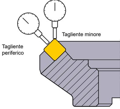
La precisione di eccentricità del tagliente di inserti intercambiabili sul corpo fresa influenza notevolmente la finitura superficiale e la durata di vita dell'utensile.
